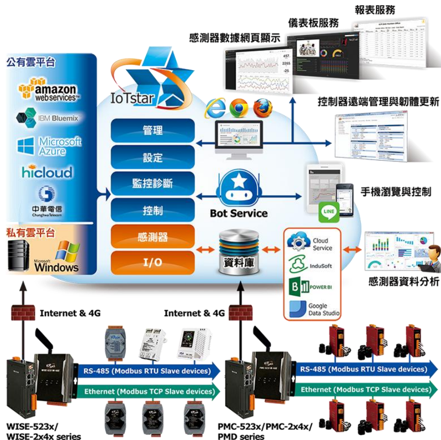
圖 1-1：IoTstar 系統架構圖
